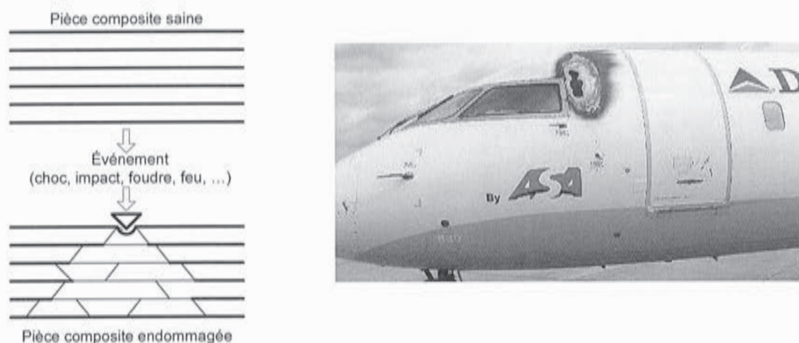
Figure 2. Principe et exemple d'endommagement de la structure vitale
