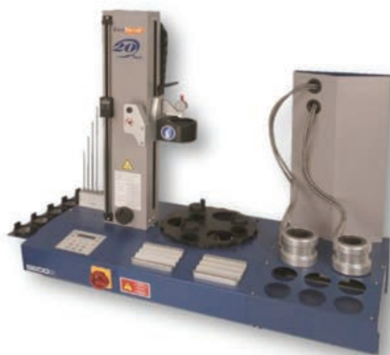
Figure B3 : la machine à fretter des outils sur des porte-outils.
