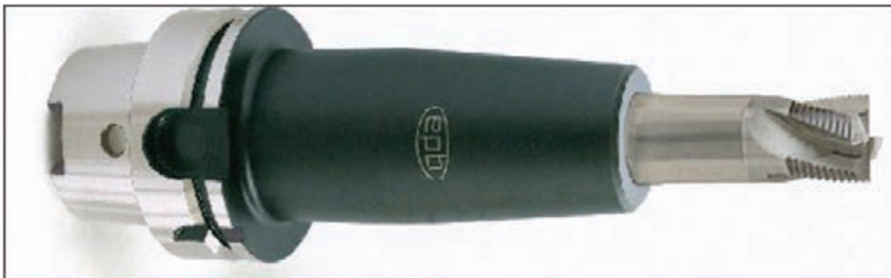
Figure A3 : un outil monté sur un porte-outil à fretter.
