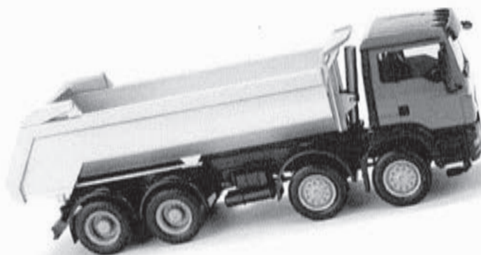
figure 27 Camion MAN TGS 32.360/400/440 8X4 BB en charge sur la rampe de la fouille
