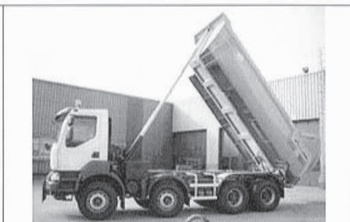
figure 26 benne ronde VINCENT de masse 3,4 tonnes
