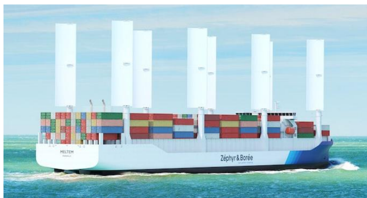
Figure 1 – Meltem Porte conteneur de Zéphyr et Borée, dotée de 4 paires d'ails CWS.
