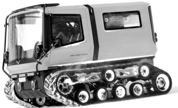
Le sujet porte sur un véhicule à impact environnemental réduit à motorisation électrique conçu pour l'exploration polaire.
