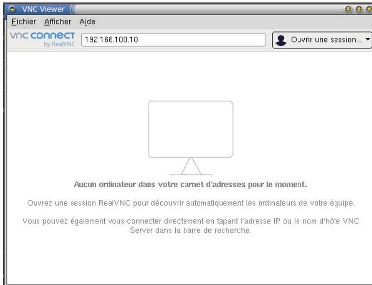
Figure 13: Connexion sur le serveur VNC de la Raspberry Pi : 192.168.100.10:5900
