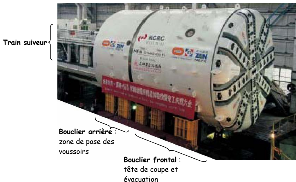
Figure 1 : vue de la partie avant d'un tunnelier (bouclier, tête de coupe)
