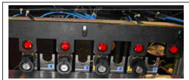
Figure 9 : Aperçu des paires de fourchettes au poste de chargement manuel (partie supérieure du chariot)
