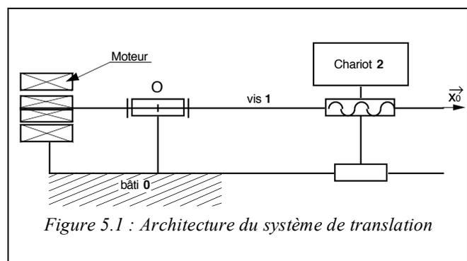
Elle est supportée à l'une de ses extrémités par une liaison pivot et à l'autre par une liaison pivot glissant. Compte tenu des contraintes de montage et de réalisation la longueur entre les appuis est égale à 3 m.
