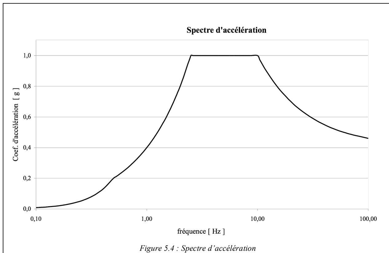
Le coefficient d'accélération est le facteur multiplicatif pour l'accélération de calage du spectre. L'accélération de calage correspond à la valeur de tangence du spectre à haute fréquence. Dans le cadre
