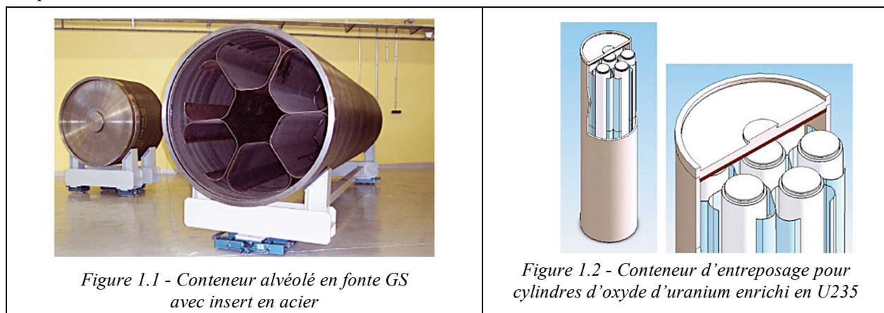
Les conteneurs sont réalisés à partir d'un cylindre en fonte GS, de deux couronnes en acier, insérées aux deux extrémités, pour permettre le soudage du couvercle et du fond (voir annexe B1). Les cloisons internes favorisent l'évacuation de chaleur des combustibles et de maintien des étuis contenant les éléments radioactifs.
