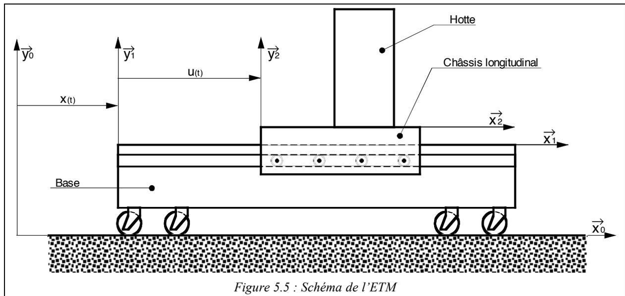
Figure 5.5 : Schéma de l'ETM
