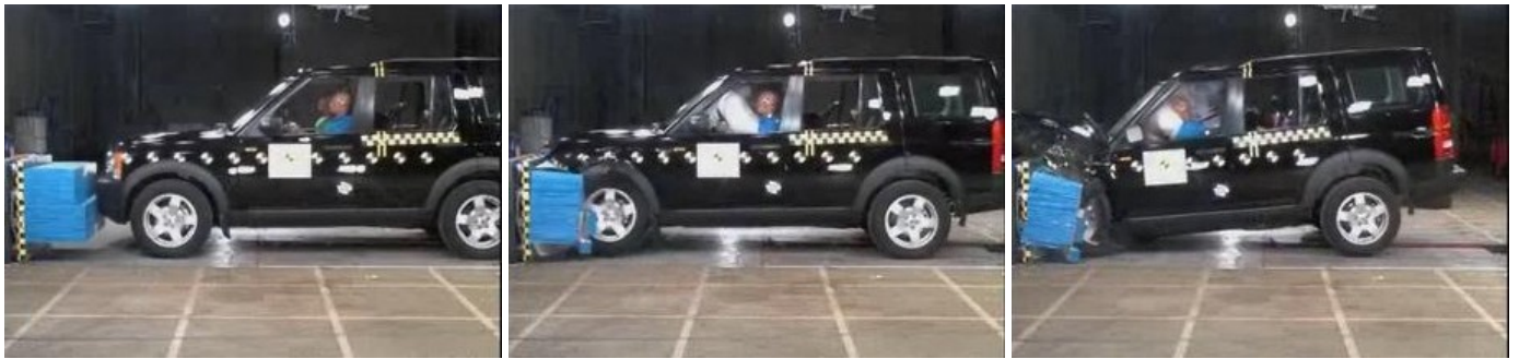
FIG. 10 – Séquence de crash-test frontal
