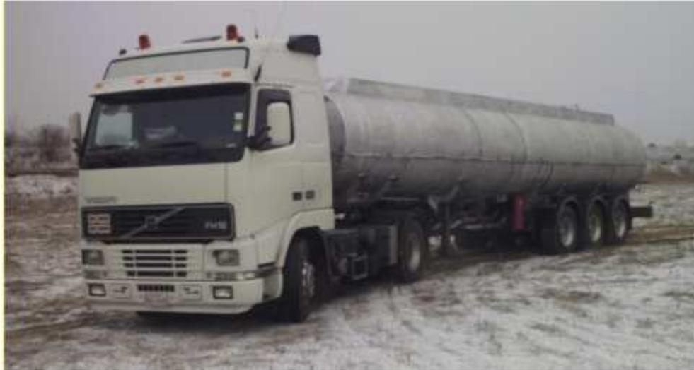
L'ensemble est constitué d'un tracteur monté sur deux essieux suspendus (ressort + amortisseurs) et d'une citerne accrochée au tracteur. La citerne repose sur plusieurs essieux.
