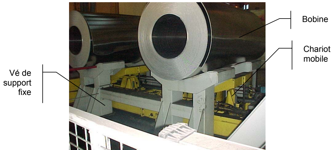
Photo 1 - Vue des bobines en attente sur le pas de pèlerin d'entrée
