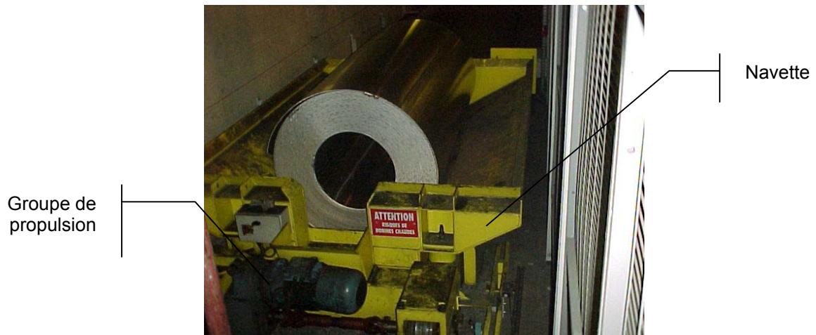
Photo 2 - Vue d'une bobine chargée sur la navette de transfert
