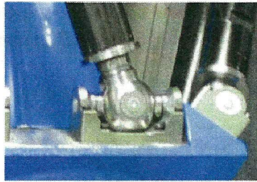
Figures 7 et 8 : vue et schéma d'une liaison cardan.
