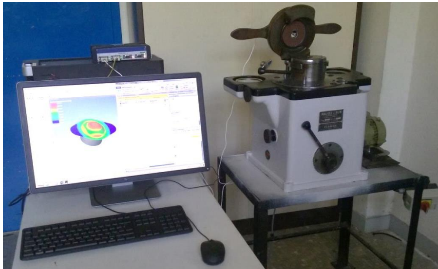
Figure 7. Machine d'essais Erichsen
