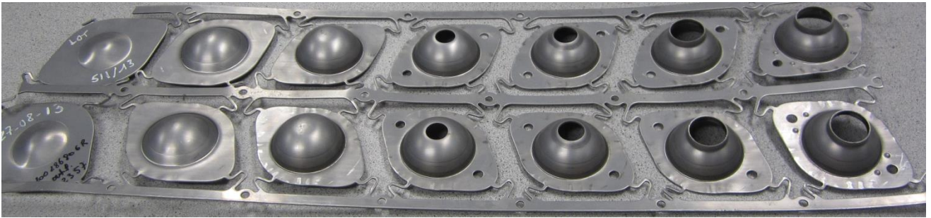
Figure 5. Mise en bande de la bride d'échappement
