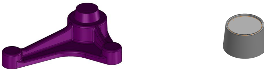
Figure h. Modèle pour la fabrication du moule supérieur (à gauche) et du moule inférieur (à droite), intégrant les portées de noyau
