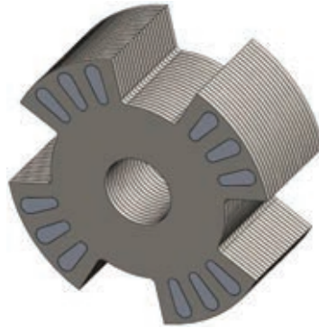
Figure B1 – Rotor utilisé dans les premiers moteurs synchrones à réluctance
