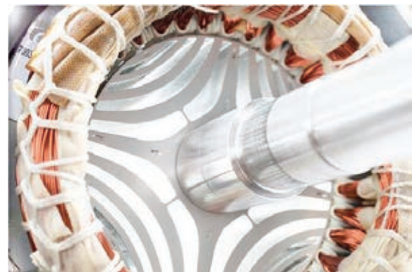
L'air peut être remplacé par un matériau amagnétique pour une meilleure tenue mécanique (photo ABB)
