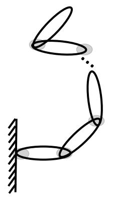
$$H(q)\ddot{q} + C(q,\dot{q})\dot{q} + G(q) = E(q)f_e + B(q)f_a$$
