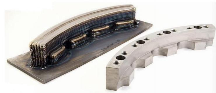
Exemple de Pièce Réalisées en W.A.M
