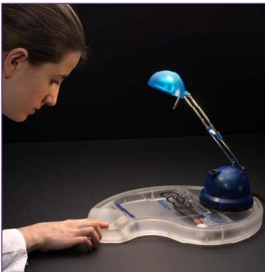
Lampe dotée d'un interrupteur : la chaleur du doigt suffit à générer une impulsion déclenchant un interrupteur
