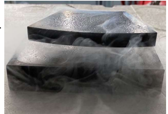
Lévitation d'un massif supraconducteur commercial en GaBaCuO refroidie par de l'azote liquide au dessus d'un aimant permanent
